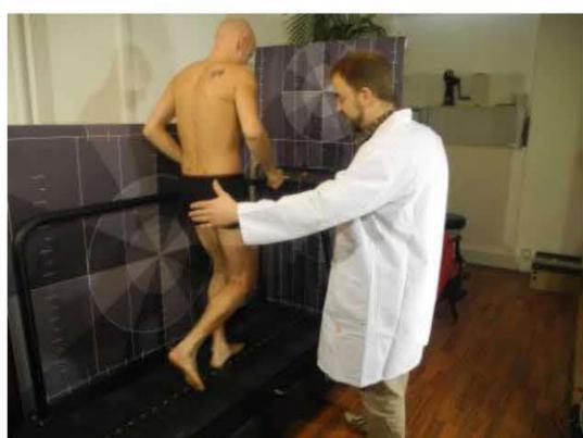
Avant de commencer l'analyse de marche, une séance d'échauffement s'impose afin de préparer le corps à l'exercice. Il est important de noter que le tapis de marche est constitué de 65 lamelles en caoutchouc et de 2 roulements indépendants. Ces lamelles procurent au coureur un confort et une sensation de marche et de course naturels.
